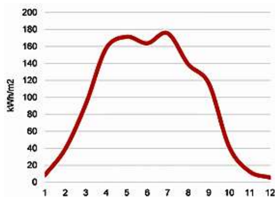
Kuva 15. 45 asteen kulmassa etelään päin suunnatun pinnan auringon kokonaissäteilyenergian määrä Suomessa (Motiva 2019a).
