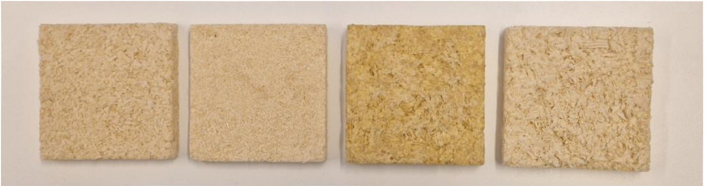
Kuva: 100 x 100 mm vasemmalta oikealle: puuliima, jauhettu puru puuliima, maitoliima ja liisteri
