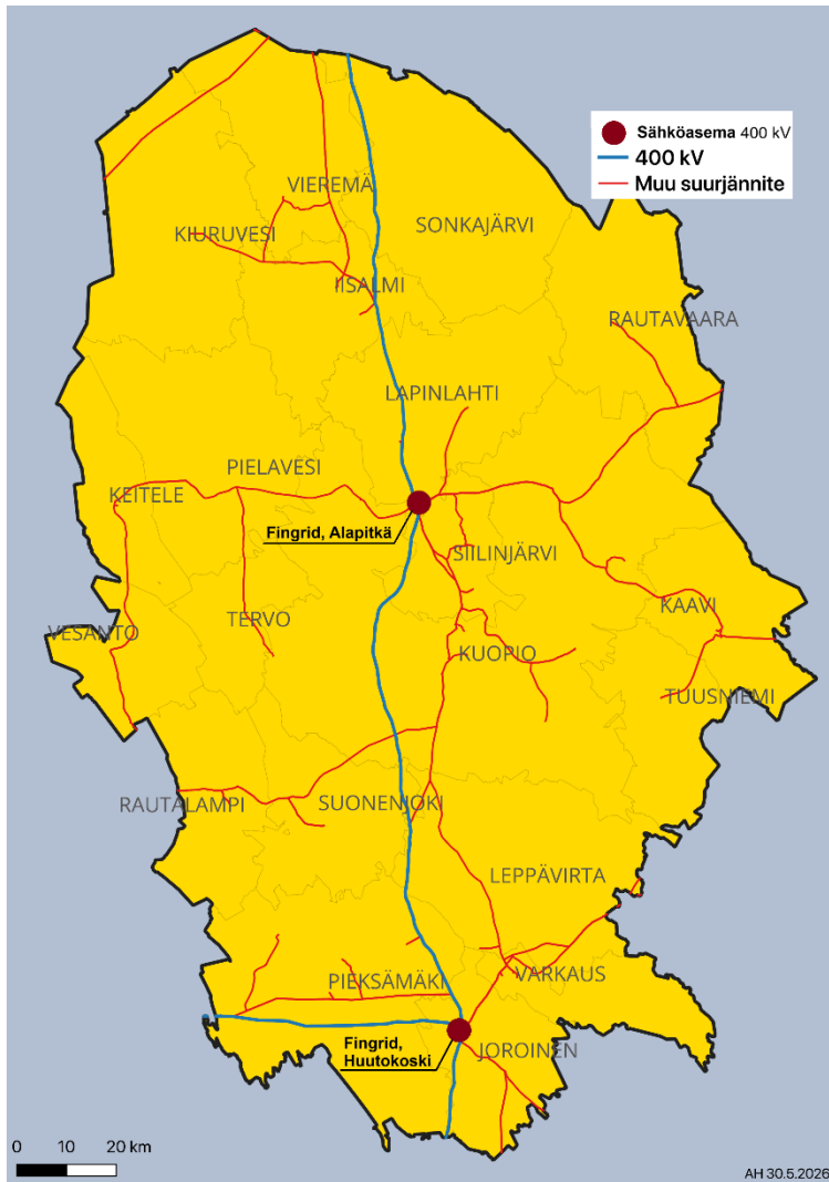
Kuva 5. Sähkönsiirtoverkon nykytila Pohjois-Savossa ja Pieksämäellä. 400 kV päävoimansiirtoverkko on merkitty sinisellä ja 110 kV suurjänniteverkko punaisella. (Pohjois-Savon energia masterplan -hankkeen kartta-aineisto, 2026)
